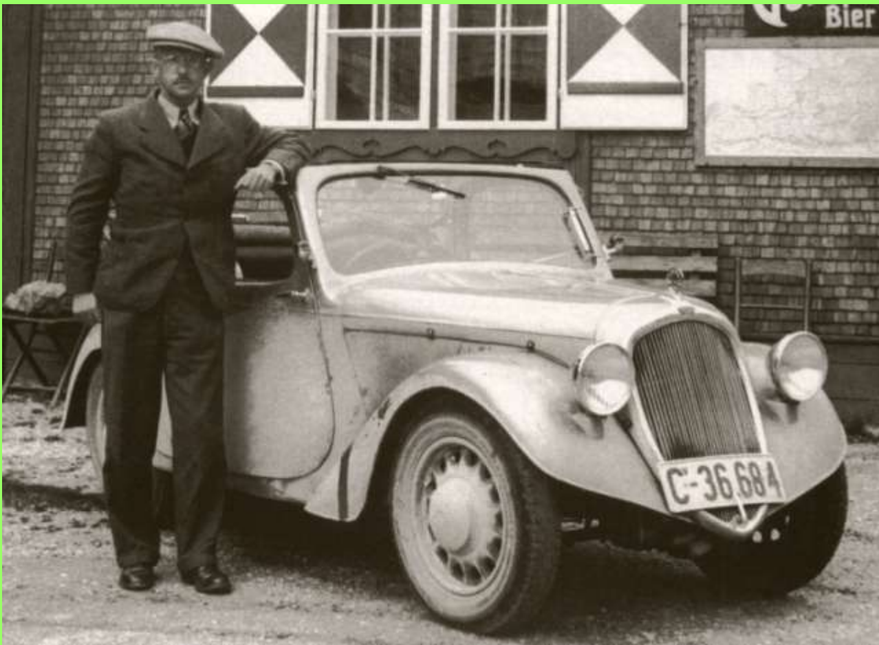
Beachten Sie den Thermometer zur Überwachung der Motortemperatur – Geber waren hinterm Zylinder
