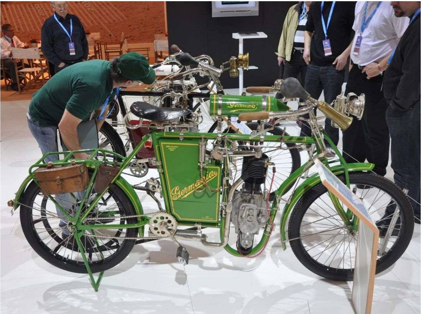
Germania, Baujahr 1904, 1 Zyl., 500 ccm, 3 PS, 60 kmh
