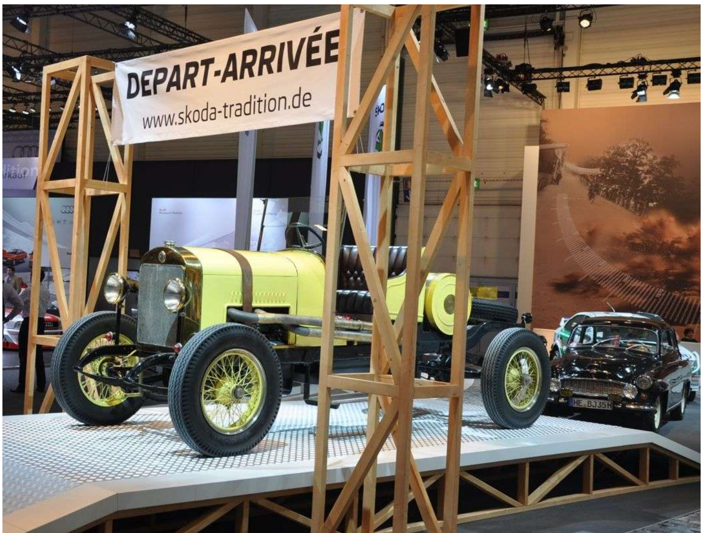
L&K 300, gebaut zwischen 1917-23, 4,7 L Motor, gesamte Produktion betrug 675 Wagen, davon 2 Rennwagen.
