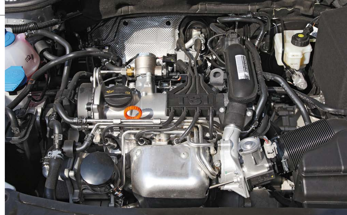
2011: DER TURBOMOTOR MIT 1,2 LITERN BRINGT 105 PS LEISTUNG
