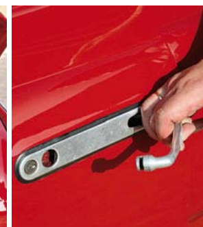
Kurios: In den Schlitz greift das Schloss ein
