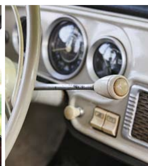
Zeitgeist pur: Lenkradschaltung für vier Gänge
